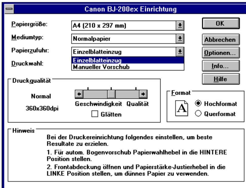
2. Klicken Sie auf die Papierzufuhr, die mit dem Drucker Canon BJ-200ex verwendet werden soll (beispielsweise "Einzelblatteinzug"). Die Dropdown-Liste Papierzufuhr wird ausgeblendet, und die ausgewählte Papierzufuhr wird angezeigt. Sie können auch die Cursortasten und drücken, um eine Zufuhr auszuwählen.
